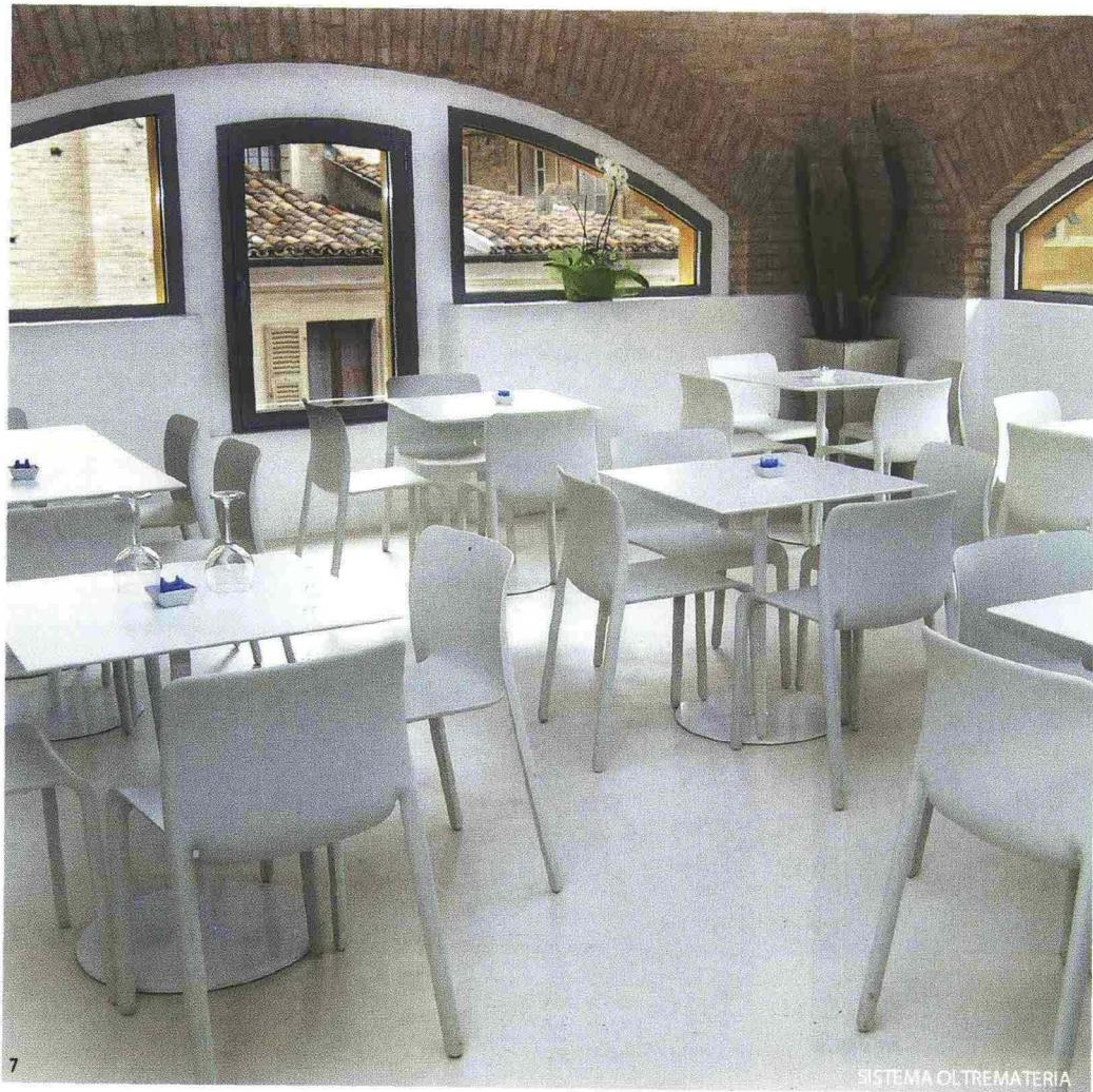
7.8. Parlare di Oltremateria significa svelare una superficie continua, realizzata con un sistema di rivestimento di eco-malta a base d'acqua, eco-compatibile e certificato. L'adattabilità del sistema Oltremateria è infinita, ed esso si può applicare su materiali diversi.
