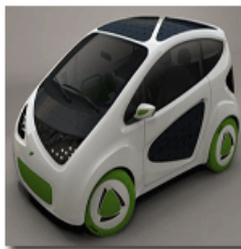
**Phylla:** Veicolo elettrico per la mobilità urbana. Per la ricarica delle batterie elettriche utilizza un sistema fotovoltaico integrato nella carrozzeria. L'auto inoltre è già pronta per le future sperimentazioni di sorgenti di energia/potenza elettrica (es: fuel cells). Minimizza i consumi energetici e le
