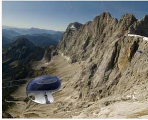
Oggi vi parliamo di un **progetto** che riguarda una **funivia** per zone turistiche di montagna auto-alimentata attraverso **pannelli fotovoltaici** posti sopra la struttura. Si chiama **Taiyou** ed è dotata di due sedili muniti di cinture di sicurezza e di un piano scorrevole sotto i sedili che permettono all'utente una miglior posizione durante il **percorso turistico**, compensando l'inclinazione quando Taiyou è in salita o in discesa.
