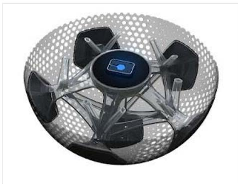
Mas há mais tecnologia. CTRUS grava sua velocidade de deslocamento e a força dos chutes. E ela possui um sistema de localização via GPS. Componentes eletrônicos em seu núcleo se comunicam, sem fios, com estações de controle no estádio.
